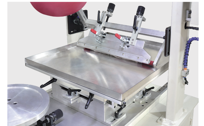
▲ 墨盘结构 Open Tray Structure
